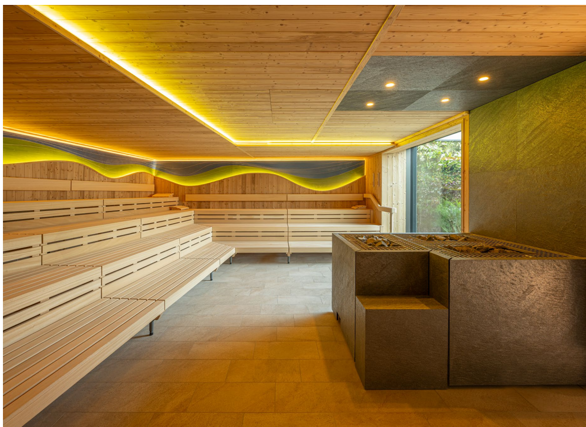
Finnische Eventsauna, ausgestattet mit 3-stufiger Liege- und Sitzeinrichtung aus Abachiholz, Decken- und Wandverkleidung aus gebürsteter Fichte
